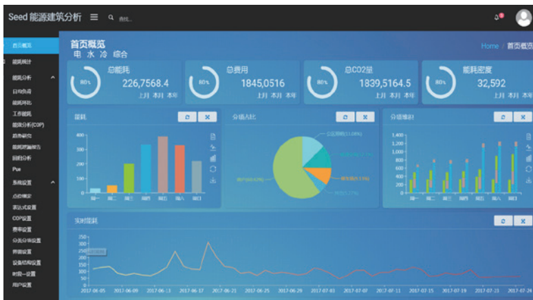
图 2-2-5 江森自控SEED能源建筑分析界面实时监测、收集能耗数据
